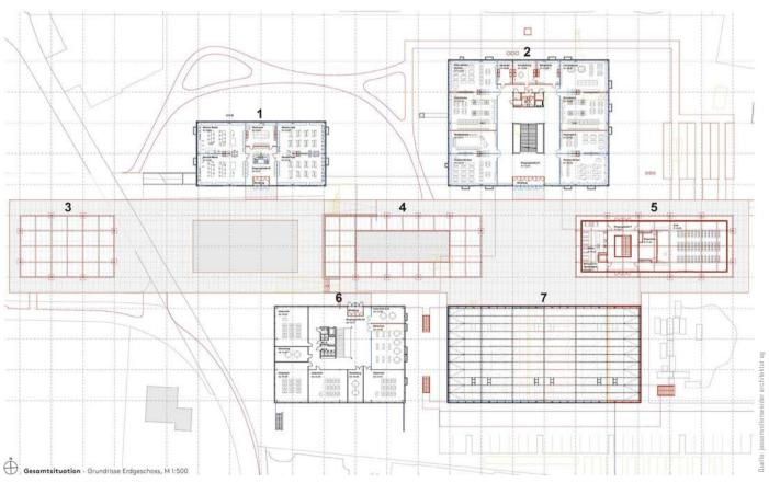
Bild 2 Grundrisse Erdgeschoss: 1 Werkstatt, 2 Auen 1, 3 Velodach, 4 Pausendach, 5 Pavillon, 6 Auen 2, 7 Sporthalle Ground floor plans: 1 workshop, 2 Auen 1, 3 velo roof, 4 break canopy, 5 pavillon, 6 Auen 2, 7 gymnasium
